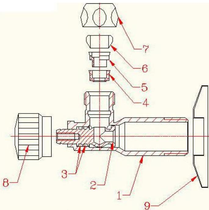
Корпус крана (1) выполнен из горячепрессованной латуни CW 617N с гальваниопокрытием из хрома. Шток с интегрированным шаровым затвором (2) изготовлен токарным способом из латуни CW 614N.
